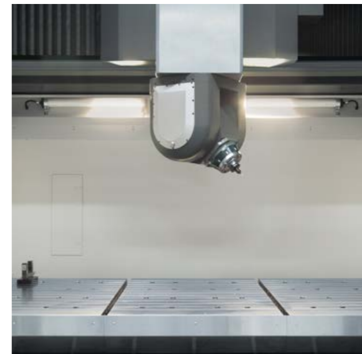
2-Achs-Schwenkkopf der VPC 45 DASK: der gesamte Kopf schwenkt um die Z-Achse (C-Achse) mit einem Schwenkbereich von \pm 360^{\circ} , während die Spindel in der Gabel um die X-Achse (A-Achse) im Schwenkbereich \pm 110^{\circ} geschwenkt werden kann
