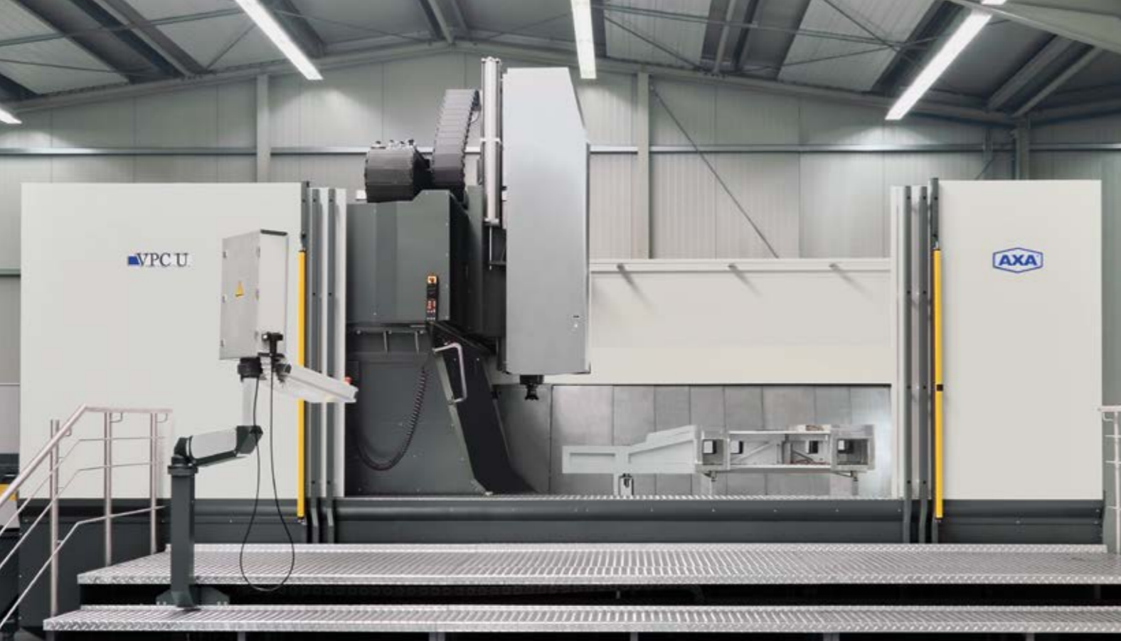
Bei der VPC 2800 U verfährt ein auf Säulen gelagerter Portalträger in X-Richtung im Gantry-Betrieb
