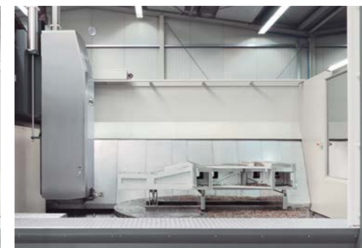
Vertikale und horizontale Bearbeitung von sehr hohen Werkstücken durch den großen Z-Hub von bis zu 1300 mm
