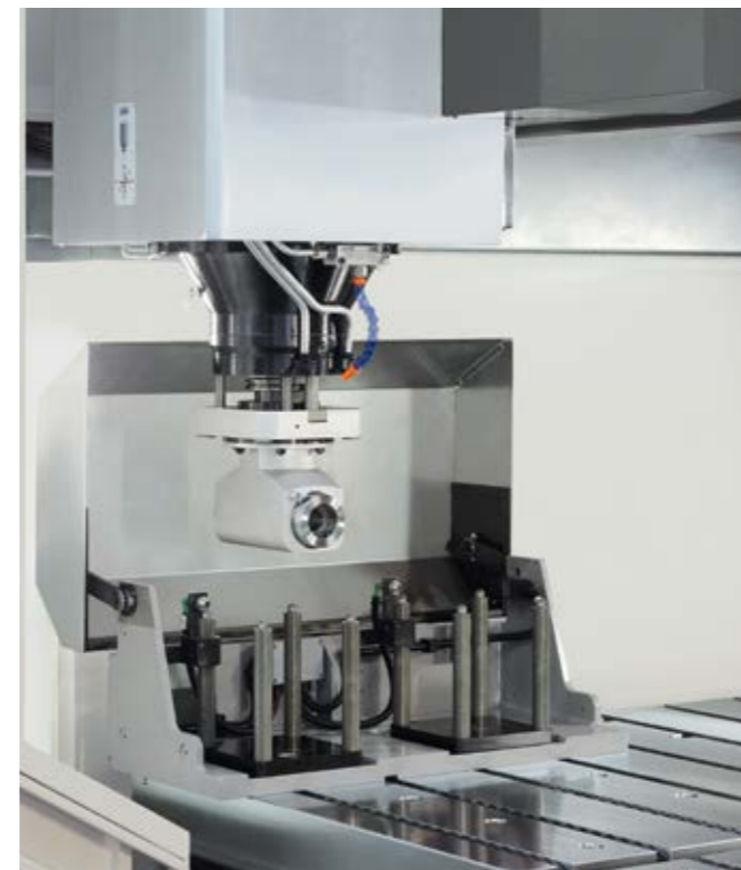
Aufnahme von einem oder mehreren Winkelköpfen durch individuell angepasste Pick up Station
