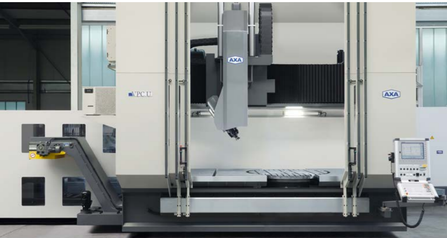
Seitlich angebrachte Werkzeugmagazintürme, beliebig erweiterbar für verschiedene Werkzeugaufnahmesysteme
