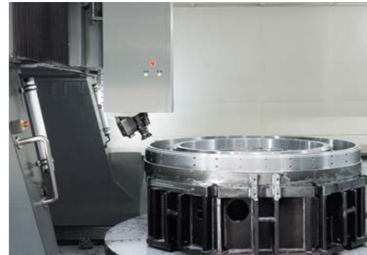
VPC 2800 U mit optionaler Vollverkleidung - bei geöffnetem Faltenbalgdach wird der Arbeitsraum für die Beladung von oben zugänglich
