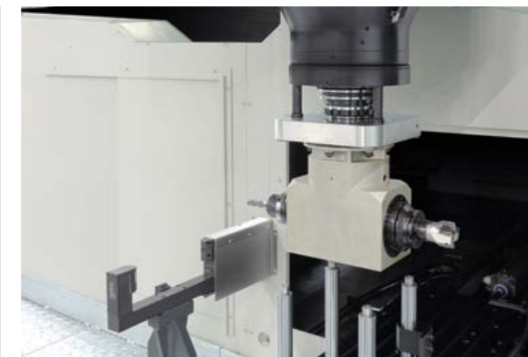
Werkzeugwechslersysteme sind in einem geschützten Gehäuse im rückwärtigen Raum, wie diese Pick up Station für weitere Werkzeuge (z. B. Winkelköpfe)
