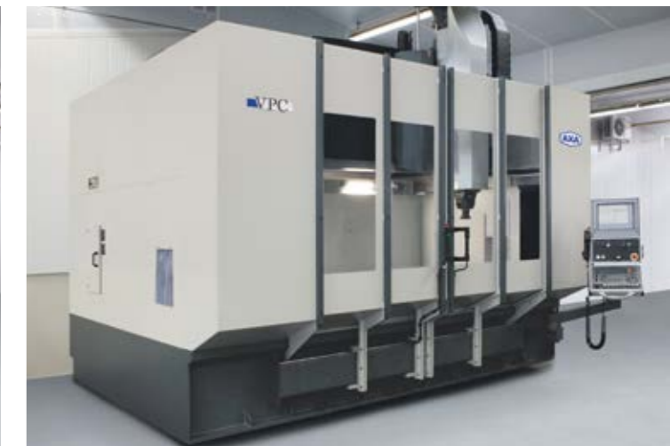
Innenliegende Türen sorgen für die notwendige Dichtigkeit
