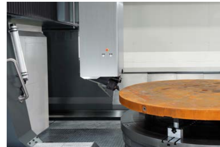
Drehbearbeitung - die separate Spanneinheit für Drehwerkzeuge sorgt für hohe Stabilität und vermeidet Belastungen der Hauptspindellagerung
