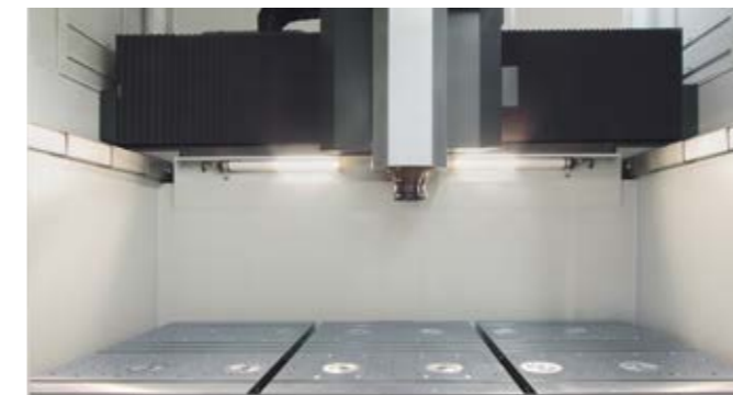
Im Tisch eingelassenes Nullpunktspannsystem für das exakte und schnelle Rüsten von Spannvorrichtungen und Werkstückpaletten
