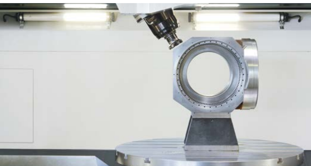
Höchste Genauigkeit: 5-Seiten Bohr- und Fräsbearbeitung eines AXA Schwenkkopfgehäuses, ideal für die Bearbeitung von Bauteilen in einer Aufspannung
