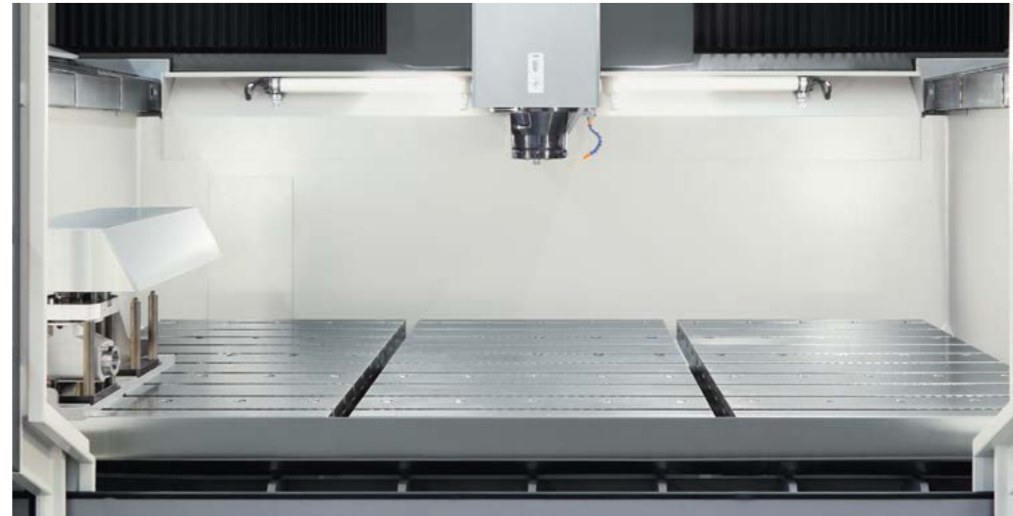
Zusätzlich angebrachte Pick up Station am Rande des Arbeitsraumes für den Einsatz von Winkelköpfen und übergroßen Werkzeugen
