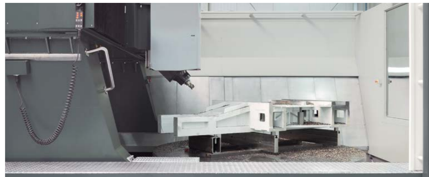
5-Seiten- und 5-Achs-Bearbeitung großer kubischer Werkstücke durch Schwenkkopf und Rundtisch der VPC 2800 U
