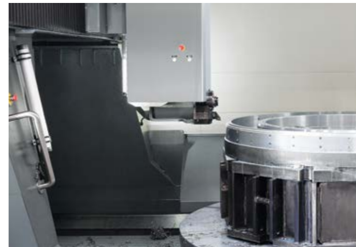
Drehbearbeitung - die separate Spanneinheit für Drehwerkzeuge sorgt für hohe Stabilität und vermeidet Belastungen der Hauptspindellagerung
