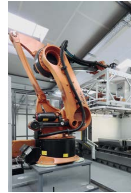
Roboter sind in der Lage, hohe Werkstückgewichte bei großer Reichweite zu bewegen
