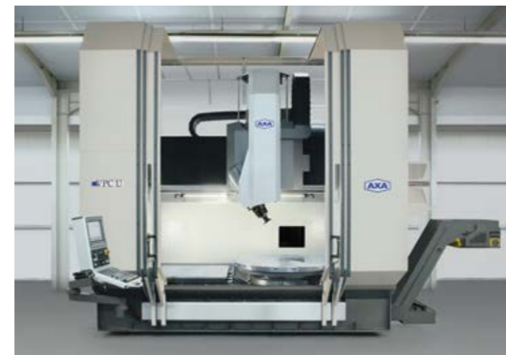
Hervorragende Zugänglichkeit und ideal für Kranbeladung durch die offene Verkleidung über dem Arbeitsraum
