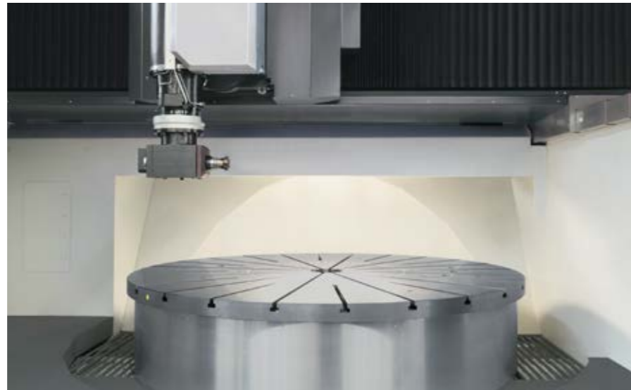
Für kleinere Ringdurchmesser können zusätzliche Winkelköpfe für die Innenbearbeitung eingesetzt werden
