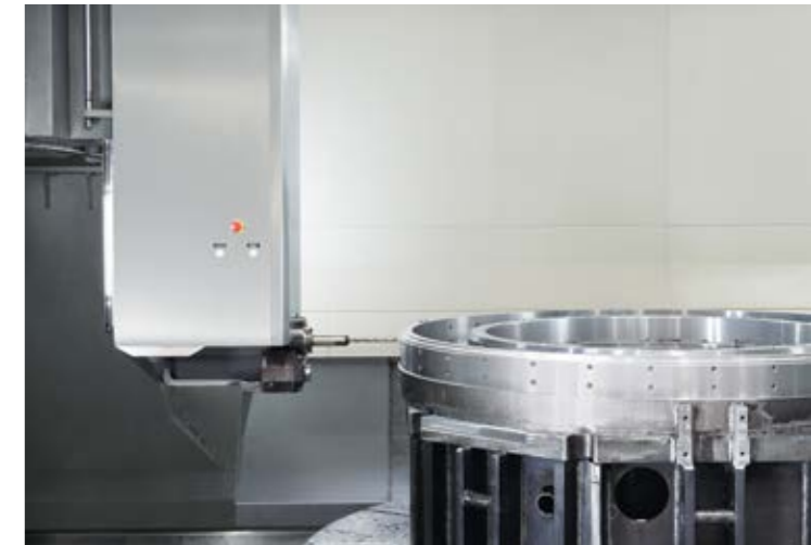
VPC 2800 U mit optionaler Vollverkleidung - bei geöffnetem Faltenbalgdach wird der Arbeitsraum für die Beladung von oben zugänglich
