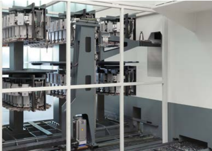
Das Werkzeugwechselsystem ist gut geschützt seitlich im hinteren Arbeitsraum angebracht
