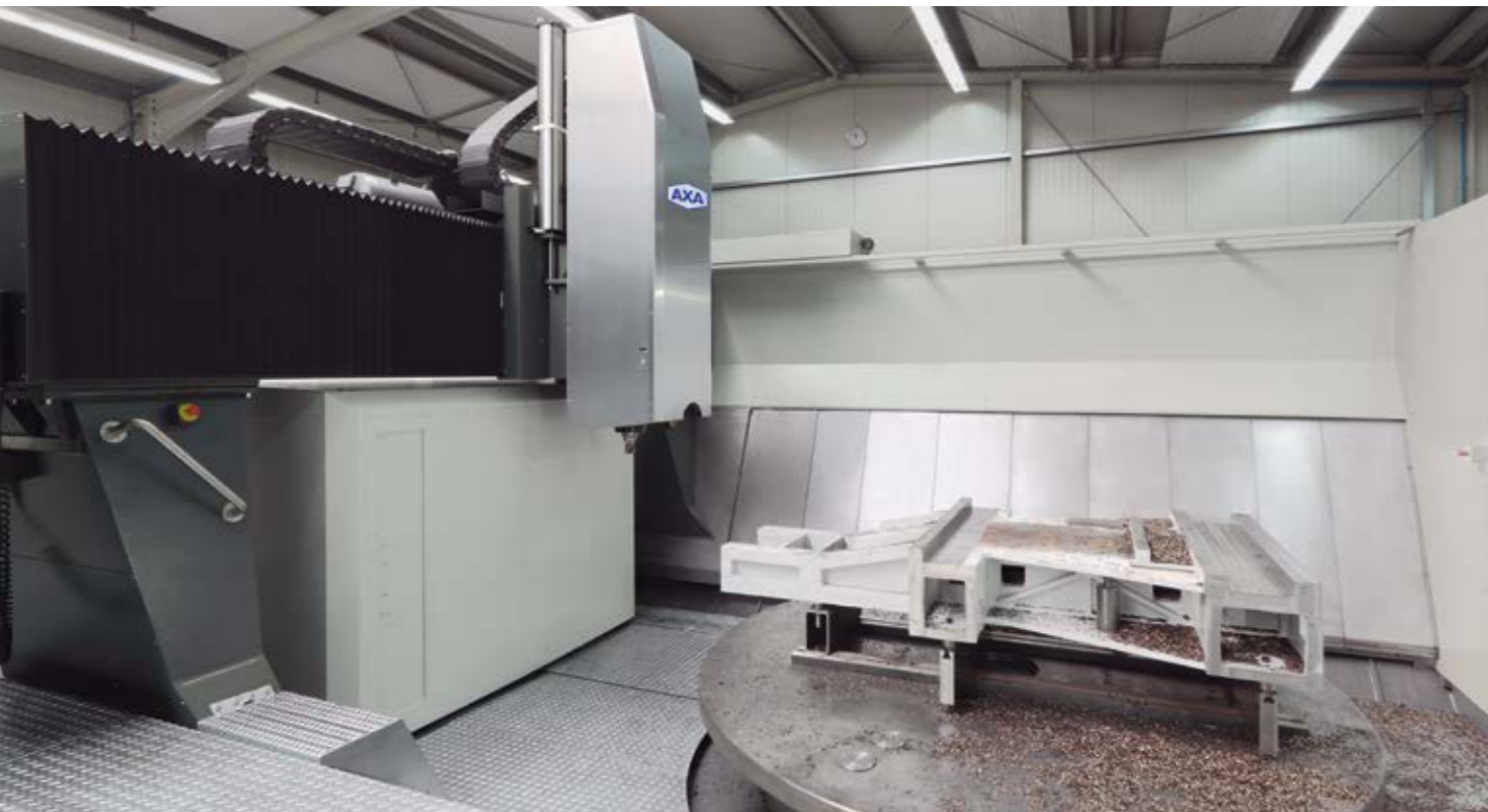
Der Arbeitsraum der VPC 2800 U mit 1-Achs-Schwenkkopf und Rundtisch ist aufgrund der niedrigen Bauweise optimal zugänglich und einsehbar
