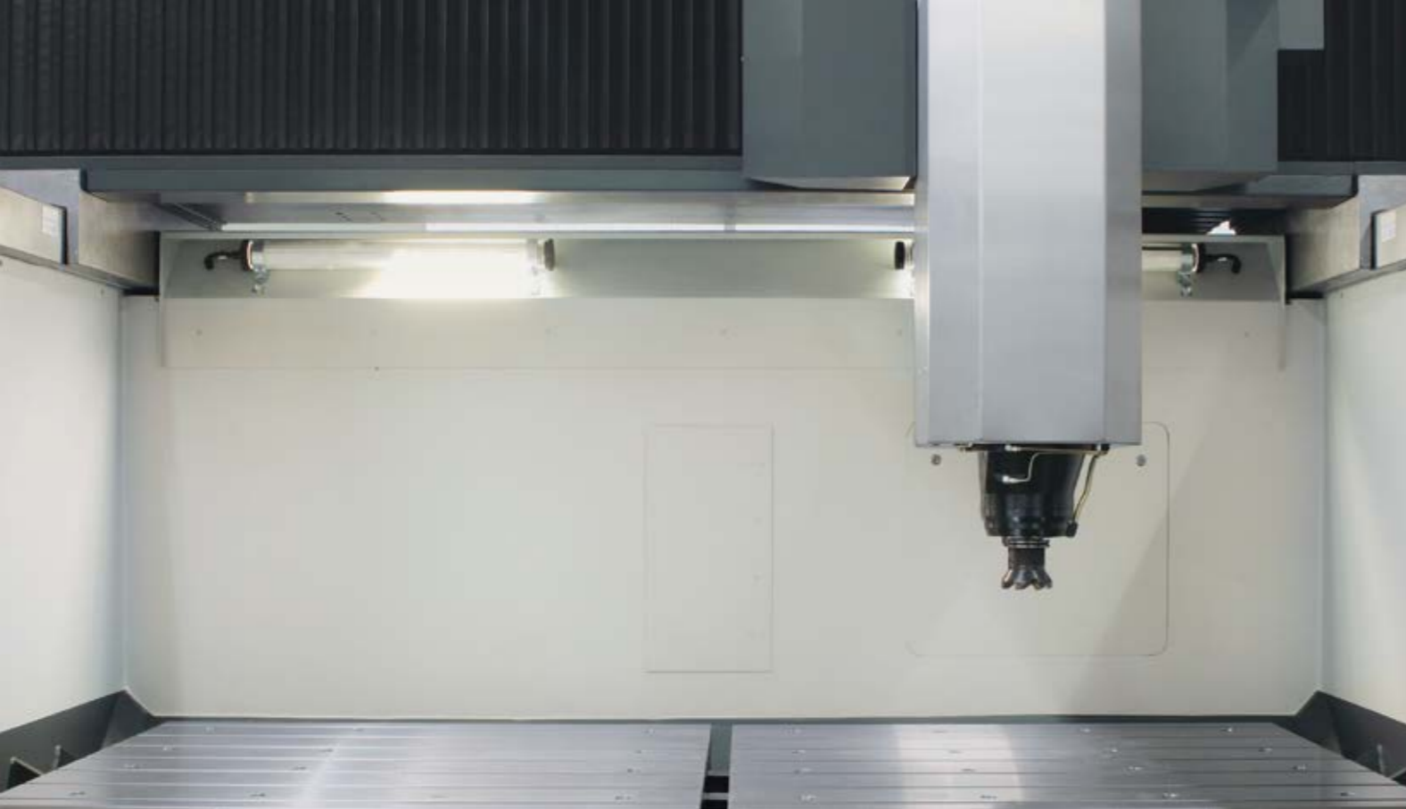
Gut zugänglicher Arbeitsraum aufgrund der niedrigen Einlegethöhe und der großzügigen Türöffnung
