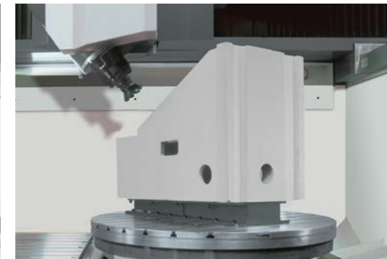
5-Seiten-Bearbeitung großer kubischer Werkstücke durch Schwenkopf und Rundtisch der VPC U
