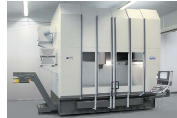
CE-konforme Rundumverkleidung mit optionaler Vollverkleidung und Absauganlage
