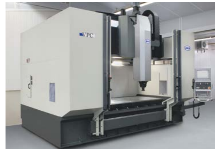
Die Maschine ist serienmäßig mit einer oben offenen Rundumverkleidung ausgestattet
