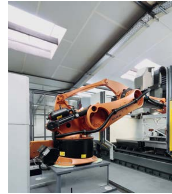
Einsetzen der Werkstückpalette in das Nullpunktsystem des Bearbeitungszentrums
