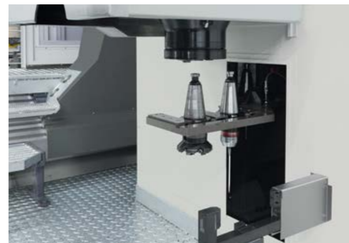
Werkzeugwechslersysteme sind in einem geschützten Gehäuse im rückwärtigen Raum, wie diese Pick up Station für weitere Werkzeuge (z. B. Winkelköpfe)
