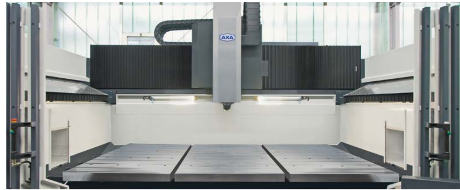
Arbeitsräume mit bis zu 3400 mm in X und 2200 mm in Y bieten viel Platz für große Werkstücke und deren Spannvorrichtungen
