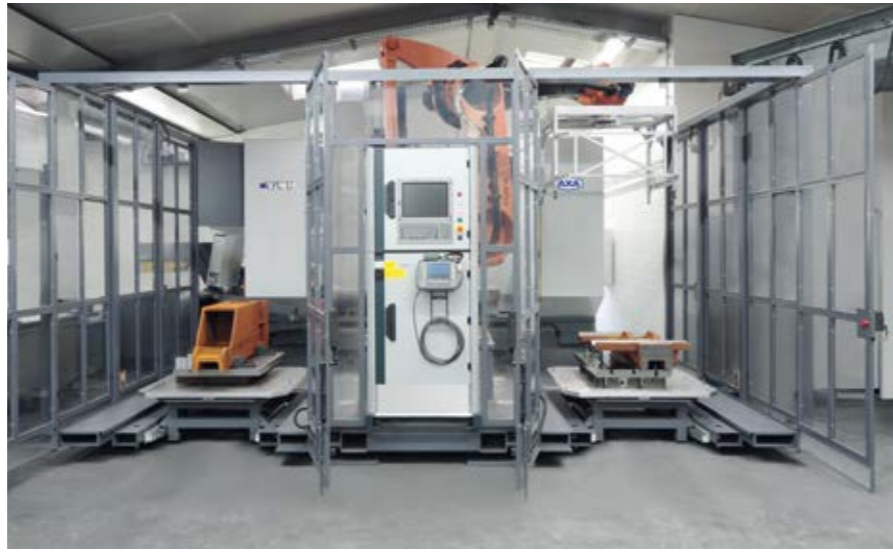
VPC mit zwei vorgelagerten Palettenplätzen für die Bestückung der Maschine
