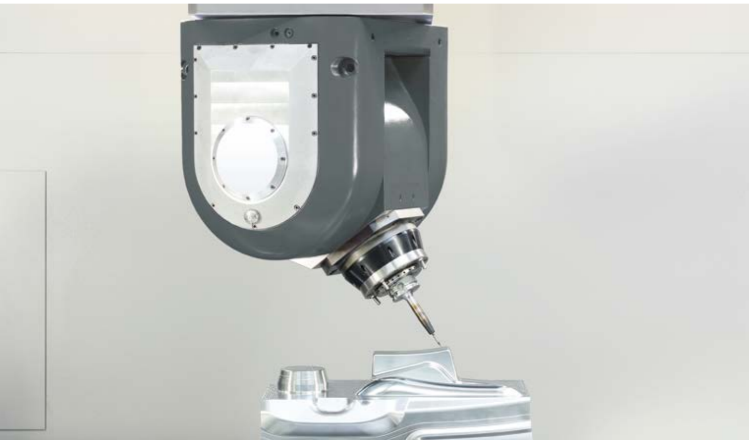
Schwenken um Z (C-Achse) und X (A-Achse)
