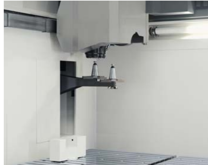
Der Übergabedoppelgreifer für kurze Werkzeugwechselzeiten
