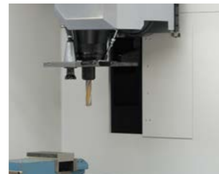
Kurze Werkzeugwechselzeiten durch den Doppelgreifer
