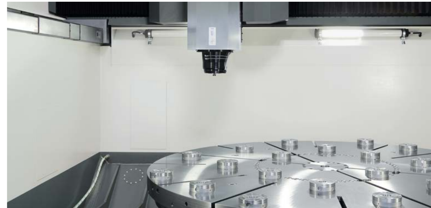
Flexible, an den Bedarf angepasste Nullpunktspannsysteme gewährleisten die präzise Ausrichtung und Spannung der Werkstücke
