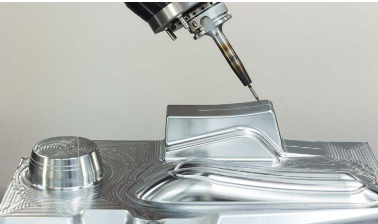
Der Torque Antrieb verleiht dem Gabelkopf höchste Beschleunigung
