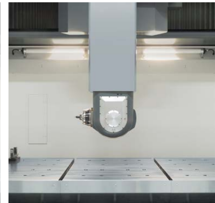
2-Achs-Schwenkkopf der VPC 45 DASK: der gesamte Kopf schwenkt um die Z-Achse (C-Achse) mit einem Schwenkbereich von \pm 360^{\circ} , während die Spindel in der Gabel um die X-Achse (A-Achse) im Schwenkbereich \pm 110^{\circ} geschwenkt werden kann
