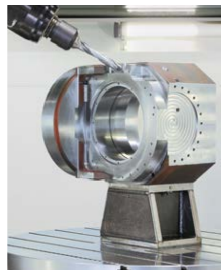
Höchste Genauigkeit: 5-Seiten Bohr- und Fräsbearbeitung eines AXA Schwenkkopfgehäuses, ideal für die Bearbeitung von Bauteilen in einer Aufspannung
