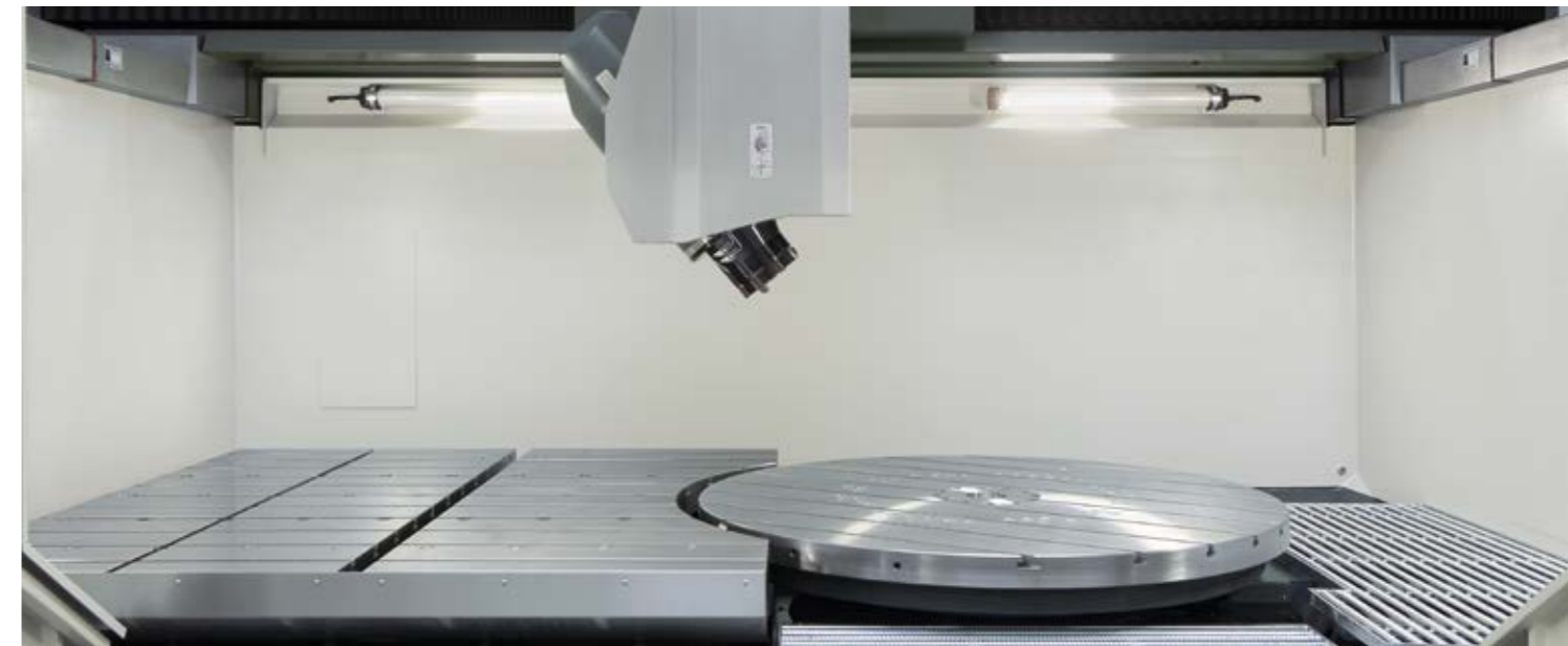
Arbeitsräume mit bis zu 3400 mm in X und 2200 mm in Y bieten viel Platz zum Durchschwenken sperriger Werkstücke
