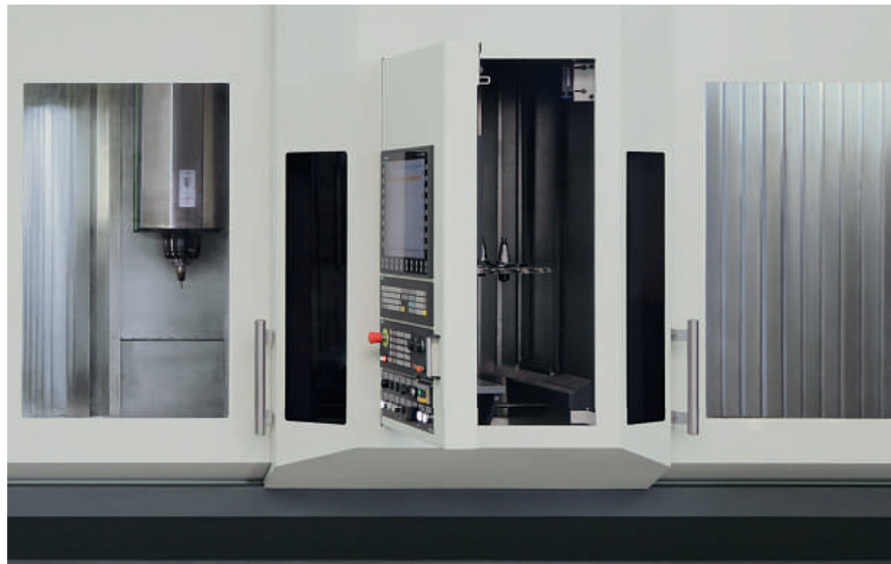
Der Werkzeugwechsler befindet sich hinter dem Bedienpult
