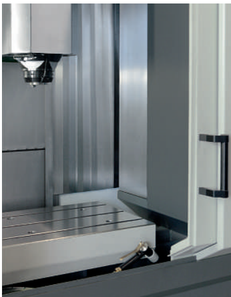
Kompakter, aufgeräumter Arbeitsraum mit direktem Zugang der Spindel zum Werkzeugmagazin
