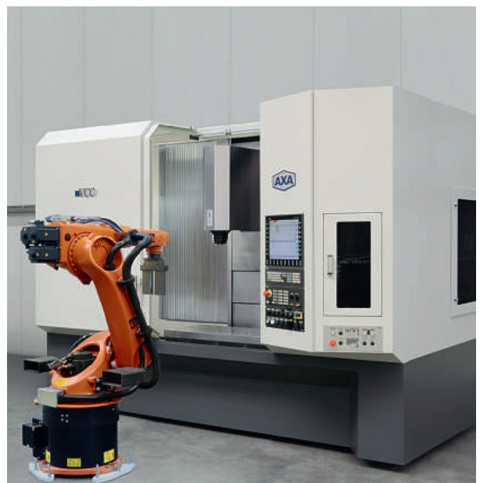
Vor dem Bearbeitungszentrum installierter Industrieroboter für die direkte Be- und Entladung der Maschine mit Werkstücken
