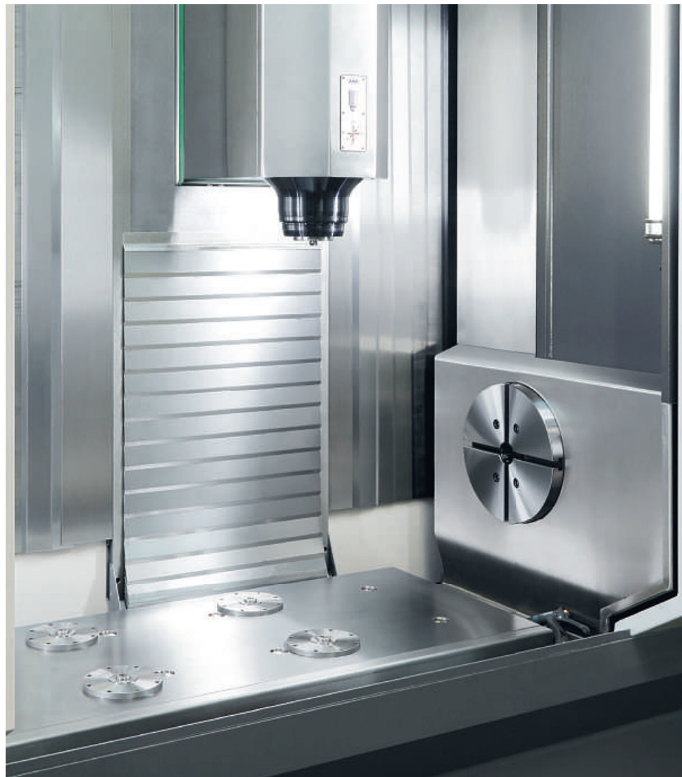
Optionale Ausstattung mit Nullpunktspannsystem und Rundtisch - keine Einschränkung in den Verfahrwegen durch die Anordnung außerhalb des Arbeitsraumes
