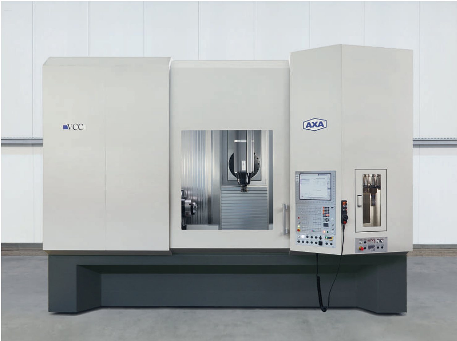
Grundaufbau der VCC 50 mit Schwenkspindel
