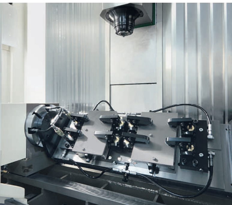
Rundtisch mit Gegenlager und Schwenkbrücke für mechanisches Mehrfachspannsystem
