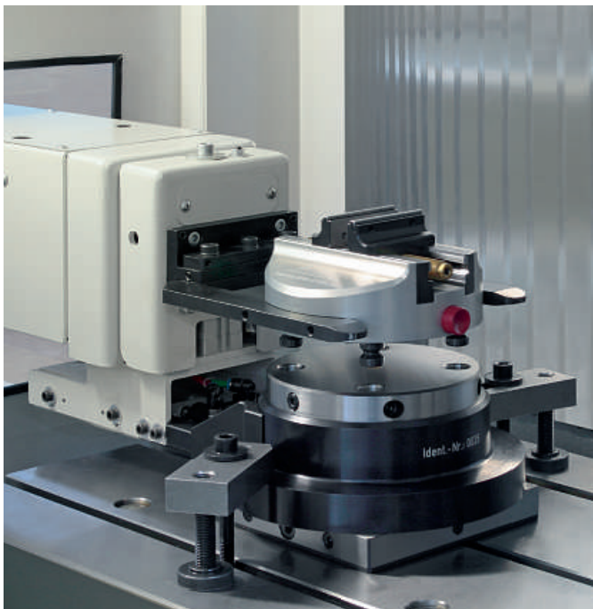
Grundkörper in Aluminiumbauweise mit integrierter Aufnahme für Handlingsysteme, Aufnahmebolzen für Nullpunktspannung und Spannmittel für das Werkstück
