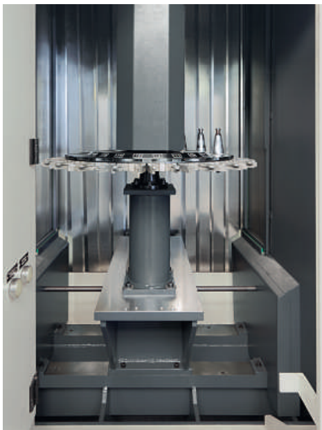
Von vorne gut zugänglicher Tellerwechsler
