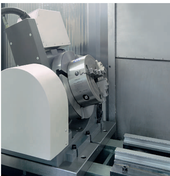
2-Achsen NC-Schwenkrundtisch von AXA mit stufenloser Rundachse 360° und Schwenkachse von 0° bis 90°
