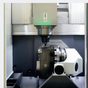
2osý otočný stůl (osy B/C) – optimální viditelnost potenciálních kolizí
