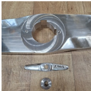
Bild_6: Auf der AXA VHC werden verschiedene Mischwerkzeuge komplett bearbeitet: Fräsen, Bohren und Nutenstoßen von 5 mm bis 40 mm Breite vertikal, horizontal oder schräg
