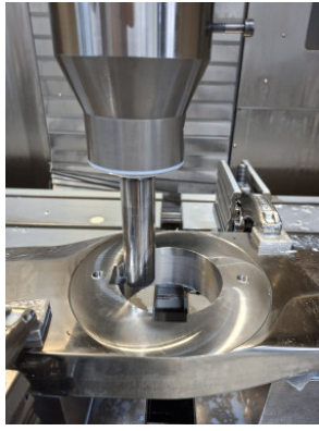
Bild_1+1a: SK50 Spindel mit spezieller Werkzeugaufnahme und 16 mm Stoßmeißel
