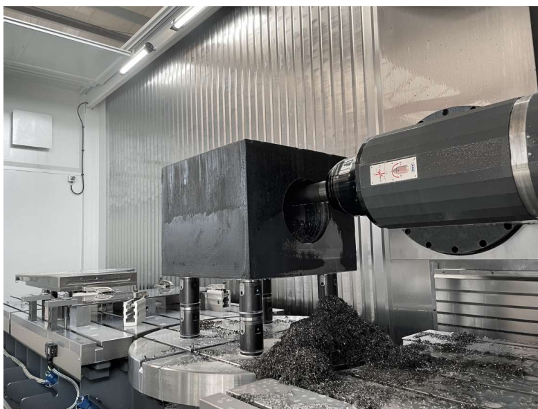
Einbringen einer Tasche mit 500 mm Durchmesser und einer Tiefe von 490 mm mit anschließender 5-Seitenbearbeitung
