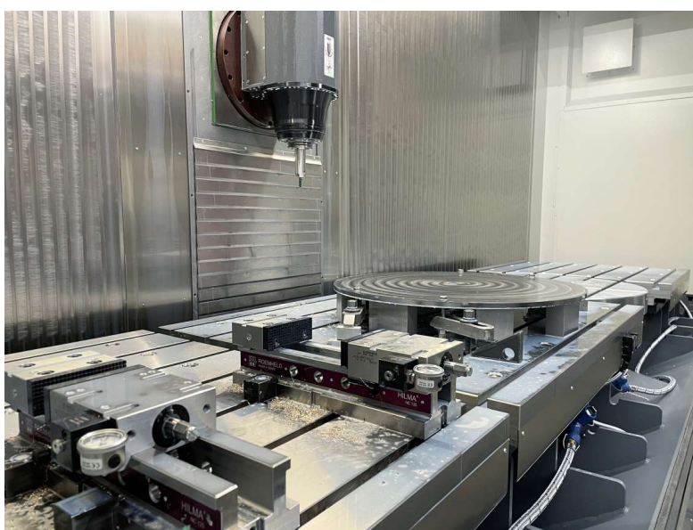
Bearbeiten von Kurvenscheiben aus Edelstahl
