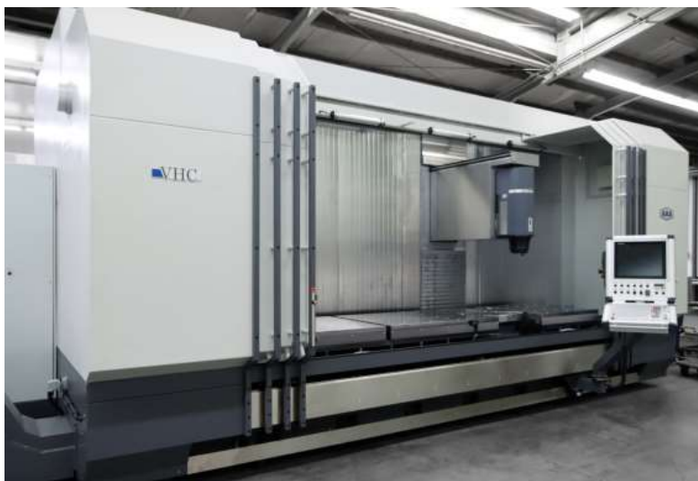
Das Fahrständer-Bearbeitungszentrum VHC 3-4000 XTS/50 von AXA: mit Verfahrwegen von 4000 mm in X und 1100 mm in Y, einer kräftigen SK 50 Spindel und stufenlosem Schwenkkopf
