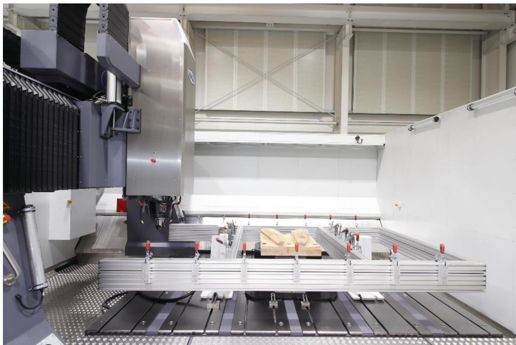
Spannrahmen mit Gegenwerkzeug (Holzwerkstoff) für das zu bearbeitende Blech
