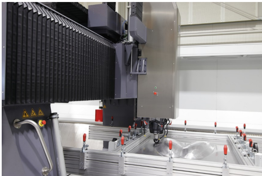
Das eingespannte Blech wird durch mehrere, aufeinanderfolgende Bewegungen des Drückdorns in Form gebracht.
